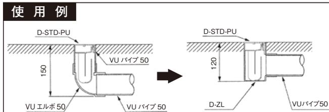
※床排水トラップ D-STD-PU(D-STS-PU)
