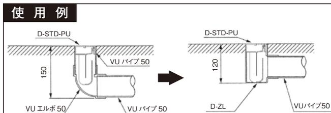
※床排水トラップ D-STD-PU(D-STS-PU)
