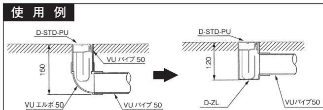
※床排水トラップ D-STD-PU(D-STS-PU)
