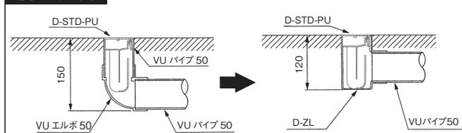
※床排水トラップ D-STD-PU(D-STC-PU)
